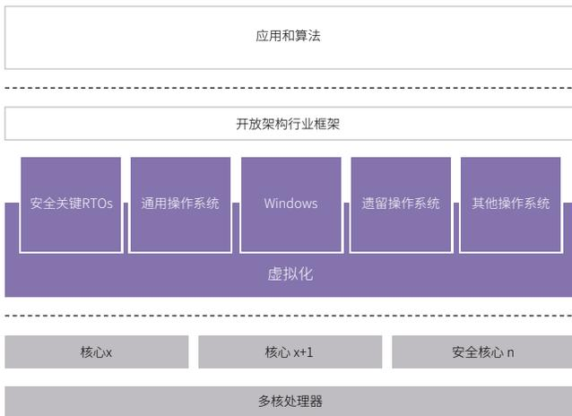
图1. 通用计算平台的软件定义架构
